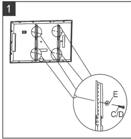
Coloque el soporte del televisor, con el lado plano hacia abajo, en la parte posterior del televisor. Coloque espaciadores y arandelas (E) entre la parte posterior del televisor y el soporte del televisor. Fije el soporte del televisor al televisor usando cualquiera de los tornillos (C o D según la marca del televisor).
