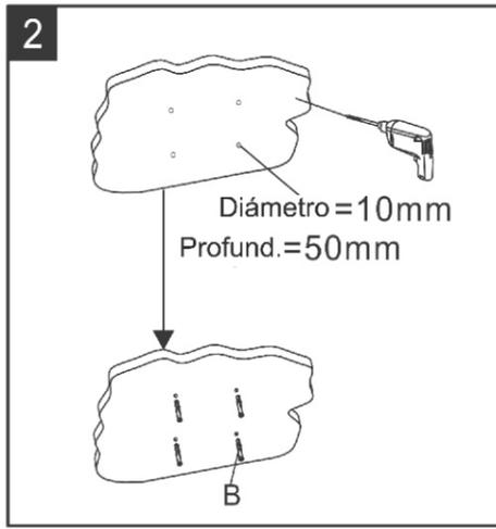
Use la cinta para determinar la ubicación adecuada para perforar agujeros para la placa de pared. Taladre los agujeros determinados en la pared, luego coloque los tarugos (B) en los agujeros.
