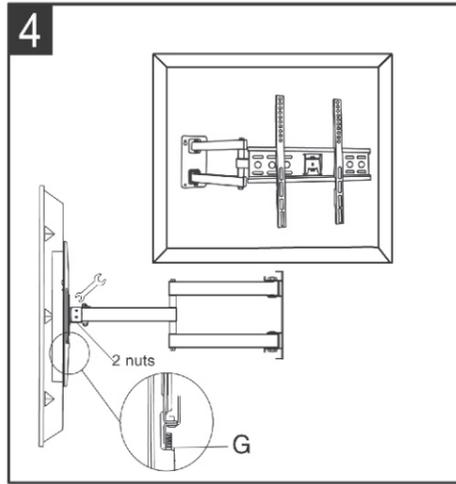
Coloque los dos ganchos del televisor con el televisor en la placa de montaje, luego bloquee el soporte del televisor apretando el tornillo (G). Puede ajustar el televisor a 0/-15° aflojando las 2 tuercas detrás del cabezal de montaje con una llave. Apriete las 2 tuercas de nuevo después de confirmar que el ángulo de TV es el correcto.
