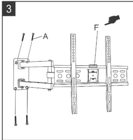
Coloque la placa de pared de modo que los orificios de montaje queden alineados con los montantes de la pared. Ponga nivel (F) en el borde superior de la placa del soporte del televisor para asegurarse de que la placa de pared esté nivelada. Fije la placa de pared a la pared usando tornillos (A) y arandelas.
