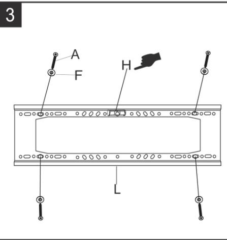
Coloque la niveladora (H) en la ranura en el centro de la parte trasera del panel (L), y presione hasta que quede completamente insertada. Asegúrese de que el panel quede en una línea horizontal. Fije a la pared usando el tornillo (A) y la arandela (F) como se muestra en la figura.
