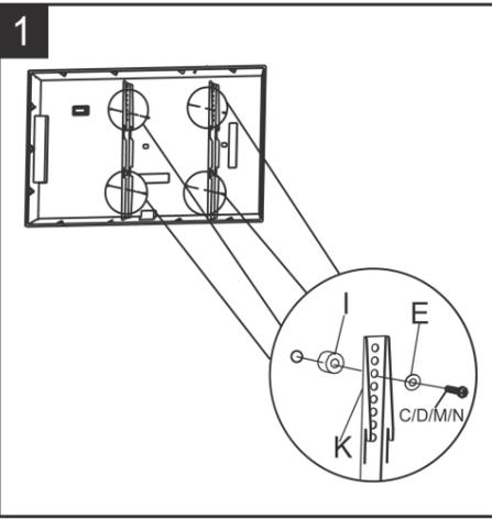
Coloque la traba de la TV (K), el lado plano hacia abajo, detrás de la TV. Coloque los separadores (I) y las arandelas (E) entre la TV y las trabas de la TV. Una la traba de la TV a la TV usando los tornillos (C, D, m o N dependiendo de la marca de TV)
