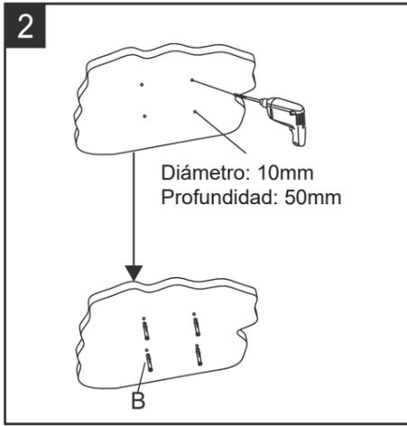
Use una cinta para determinar la ubicación adecuada para hacer los agujeros en la pared. Agujeree la pared en las marcas, colocando el ancla (B) en los agujeros.
