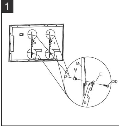
Monte la TV en los soportes, usando la arandela y el separador (G-C). Primero ponga la arandela (G), luego atornille (C-D) al separador. Ajuste los tornillos como muestra la figura.
