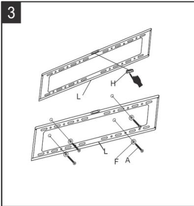
Coloque la niveladora (H) en la ranura en centro de la parte trasera del panel (L), y presione hasta que quede completamente insertada. Asegúrese de que el panel quede en una línea horizontal. Fije a la pared usando el tornillo (A) y la arandela (F) como se muestra en la figura.
