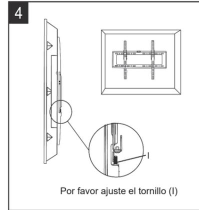
Coloque ambos ganchos de TV y la pantalla en el soporte, luego trabe los soportes de la TV ajustando los tornillos (I). Puede ajustar la TV de 0° a -10° bajando la parte de arriba de los ganchos (M) juntos.
