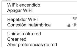
Desconectar su Ethernet (cable) de su computadora. Clickee en el símbolo WIFI en su computadora y conecte al repetidor.
